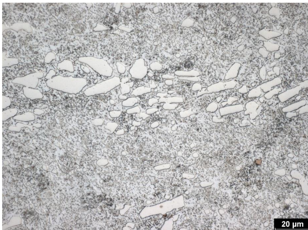
Obrázek 20 Struktura oceli X210Cr12 ve výchozím stavu (příčný řez), SM [4]
