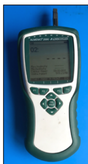
Obr. 23: Datalogger Almemo 2690 použitý k záznamu dat při provádění laboratorní zkoušky.
