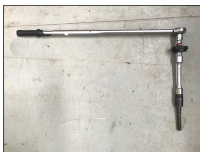
Obr. 42: Sestava momentového klíče, měřiče momentové síly a vrtule.
