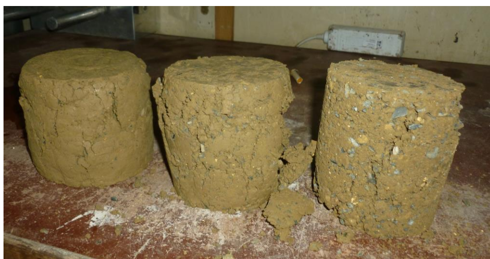
Obr. 53 Porušené vzorky po zkoušce pevnosti v tlaku
