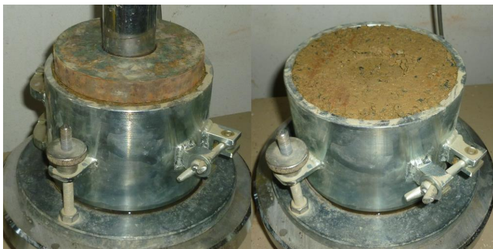
Obr. 49 Směs 0/8 CBR, \Delta w=0\%
