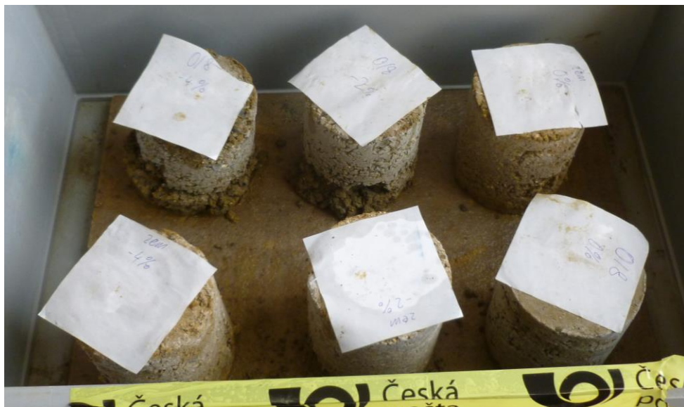
Obr. 56 Vzorky po 2. zmrazovacím cyklu
