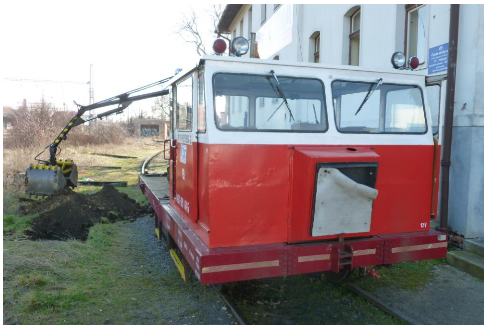
Obr. 19 MUV 69 s drapákem v ŽST Lysá nad Labem
