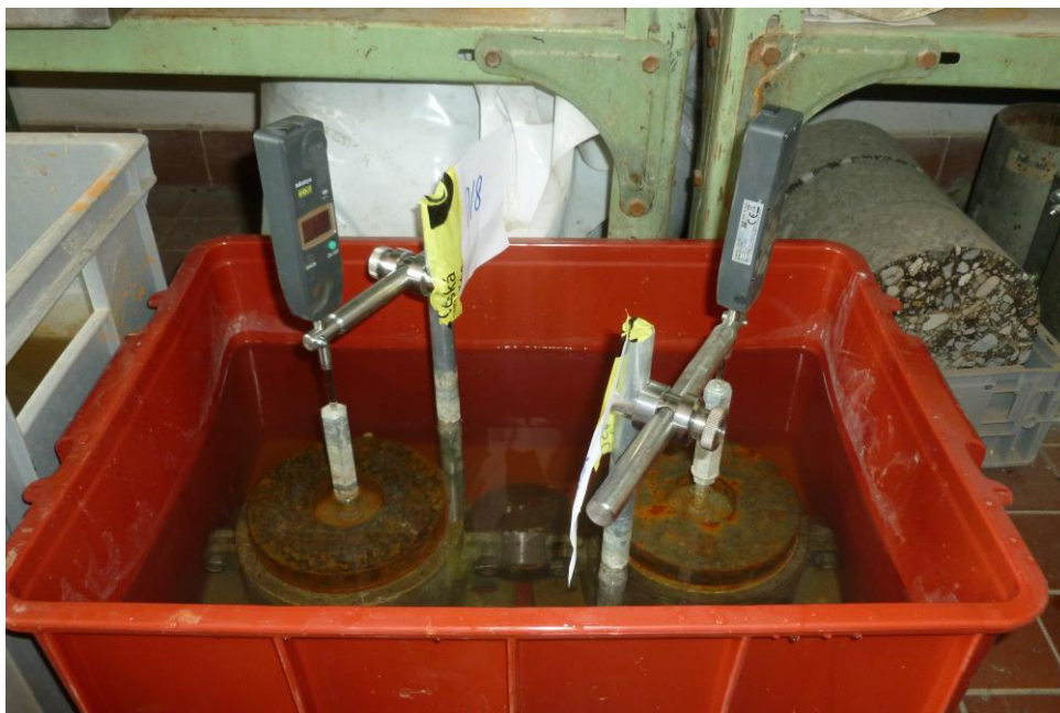
Obr. 51 Zkouška lineárního bobtnání
