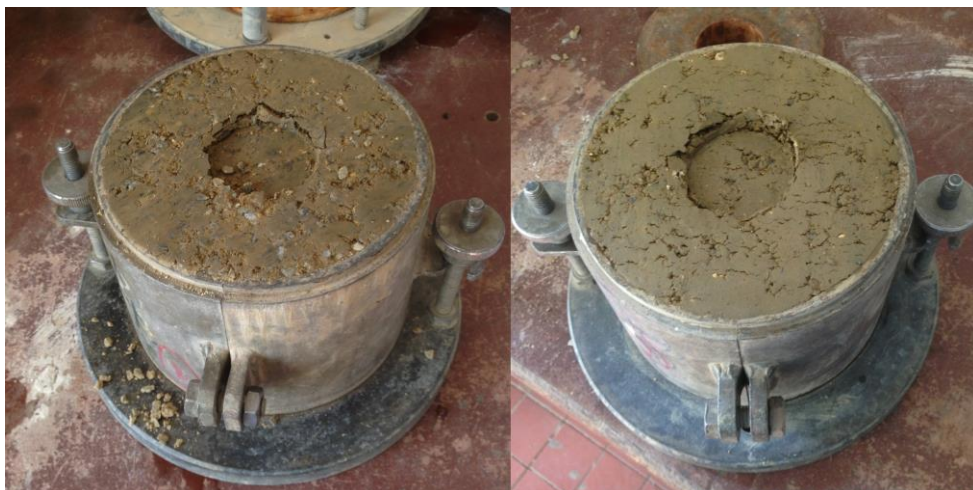
Obr. 46 Směs 0,125/4 CBR, \Delta w = -2 ; 0 %
