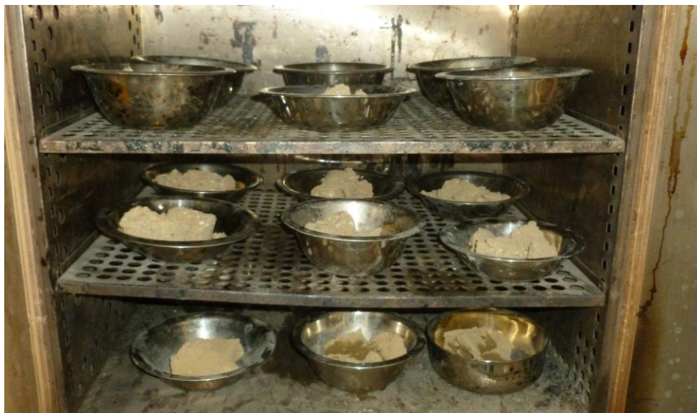
Obr. 43 Vzorky v sušárně při zkoušce Proctor Standard
