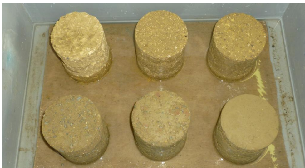
Obr. 55 Kapilární sycení na plstěné podložce
