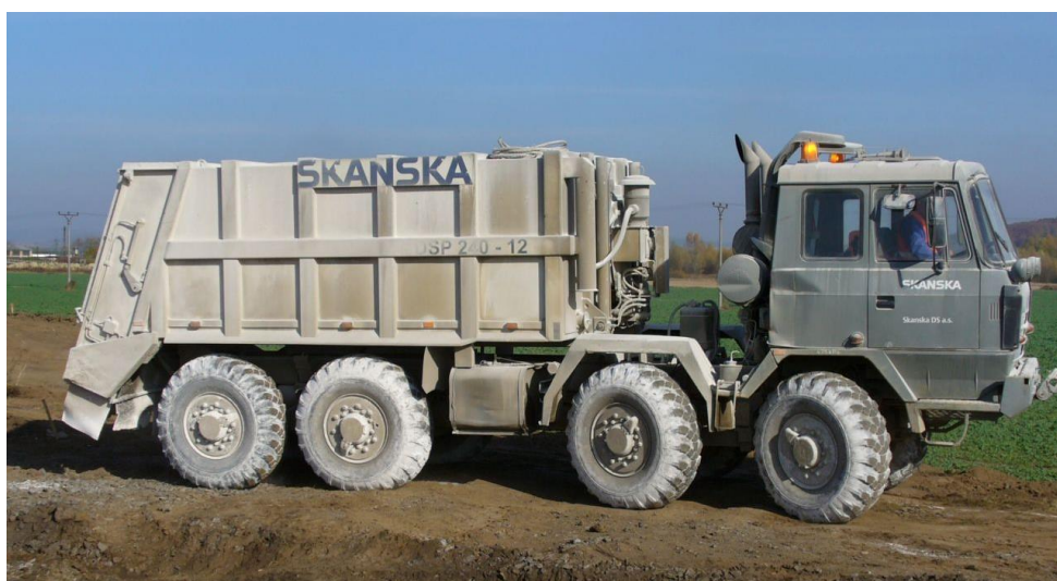
Obr. 12 Dávkovač na podvozku Tatra 815 [28]
