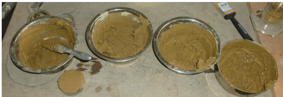
Obr. 33 Vzorky pro zkoušku meze tekutosti
