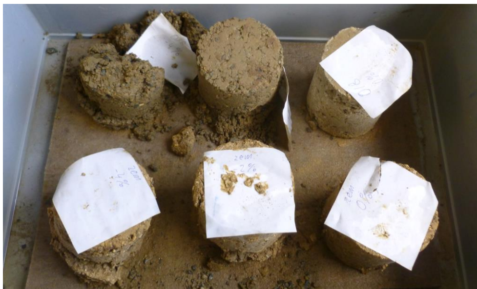
Obr. 57 Vzorky po 3. zmrazovacím cyklu
