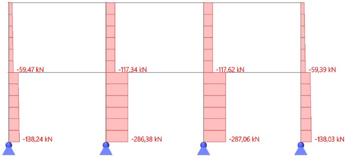
Obrázek 4 – normálové síly ve sloupech – model A
