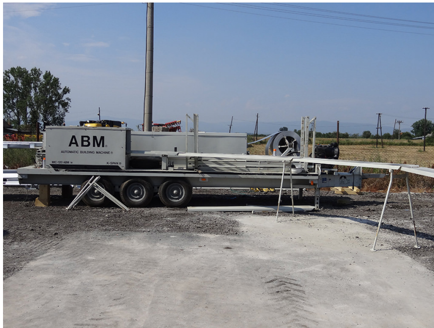
Obrázek 25: Profilování ocelového svitku (převzato z [9])
