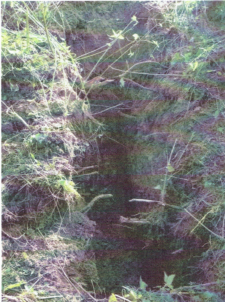
Sonda K7 v levém břehu ve svahových hlínách.
