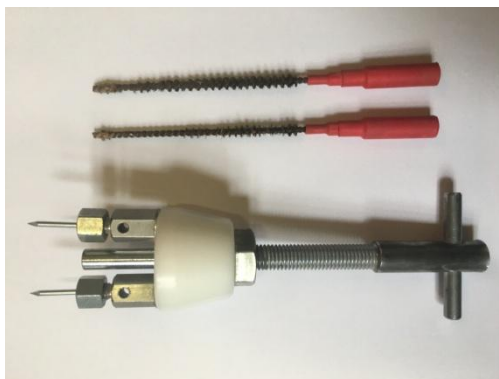
Obrázek 11 – Kartáčové elektrody (nahore), zářezací elektrody (dole), (archiv autora)
