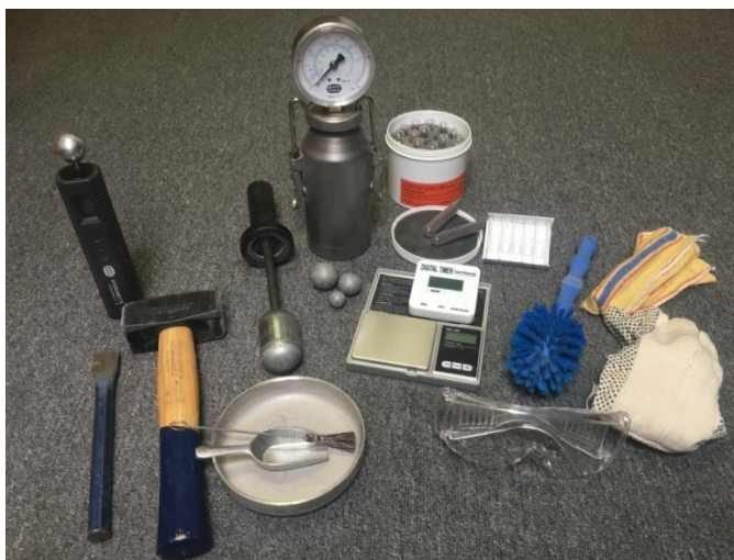
Obrázek 13 – GANN HYDROMAT CM, zleva: HYDROMETTE COMPACT B, plochý majzlík, kladivo, nádoba na úlomky materiálu, lžička, štětec, hmoždíř, tlaková nádoba s víkem a manometrem, sada ocelových kuliček, ampule s karbidem vápenatým, elektrická váha, časovač, ampule zkušební vody, kartáč na nádobu, OOPP (archiv autora)
