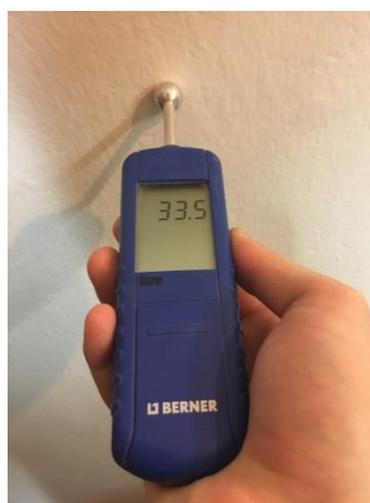
Obrázek 14 – Měření kapacitním vlhkoměrem Berner (archiv autora)
