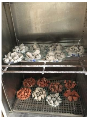
Obrázek 5 – Komorová sušárna BMT HS 202 A - vnitřní pracovní prostor (archiv autora)
