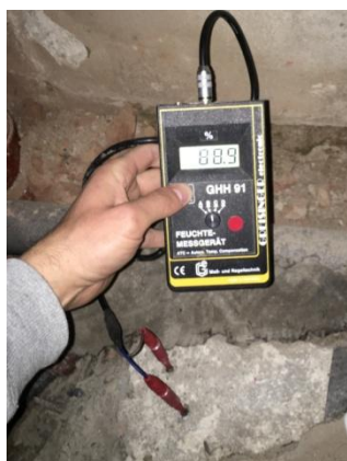
Obrázek 15 – Odporové měření pomocí kartáčových sond (archiv autora)
