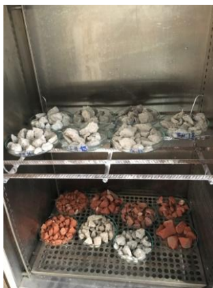
Obrázek 12 – Sušení vzorků v komorové sušárně (archiv autora)
