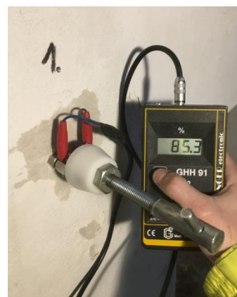
Obrázek 15 – Odporové měření pomocí kartáčových sond (archiv autora)
