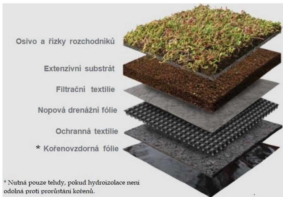
Obrázek 2: Orientační uspořádání vrstev vegetační střechy (Upraveno z: http://www.ekrost.cz/ )
