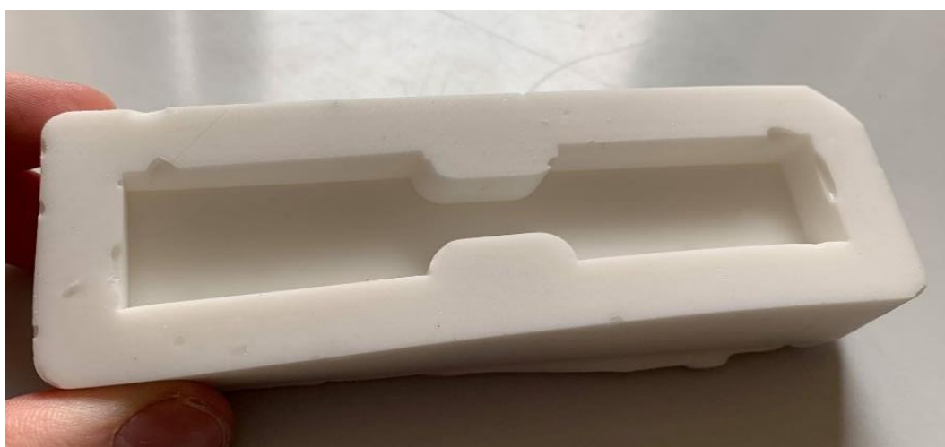
Obr. 18 Silikonová forma po vytvrzení
