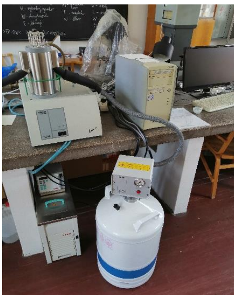
Obr. 19 Fotografie tanice pro provedení metody DSC s přístrojem NETZSCH STA 409 PG LUXX
