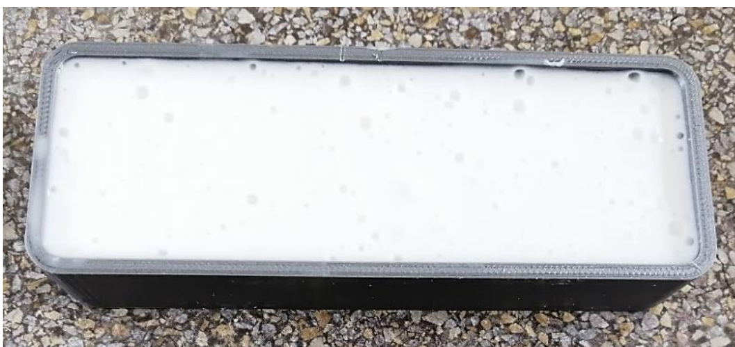
Obr. 17 Formovací silikon ve vaně před vytvrzením
