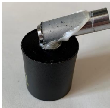
Obr. 1 Vzorek, kde je adheze ke kovu vyšší než k plasty
