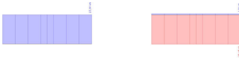
Obr. č. 55: Normálové síly na nejzatíženějším stropním nosníku
