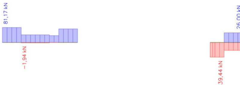
Obr. č. 61: Normálové síly na nejzatíženějším průvlatku
