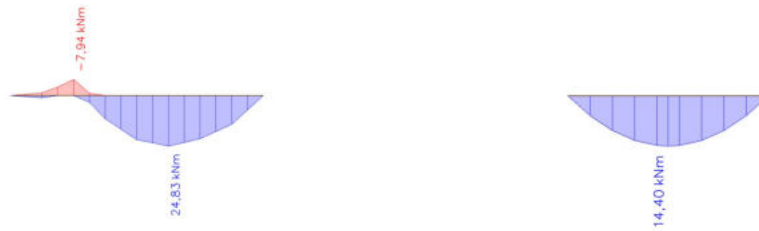
Obr. č. 63: Ohybové momenty na nejzatíženějším průvlaku
