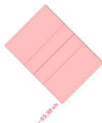
Obr. č. 35: Normálové síly na nejzatíženější vzpěře
