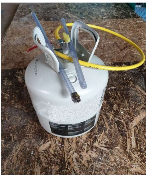
Obr. 20 - PU lepidlo v tlakové nádobě včetně aplikační sady (zdroj autor)
