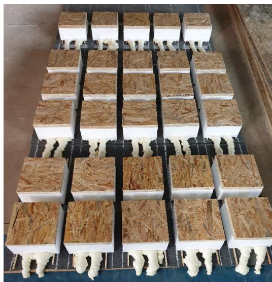
Obr. 28 - Připravené vzorky k odtrhovým zkouškám (zdroj autor)
