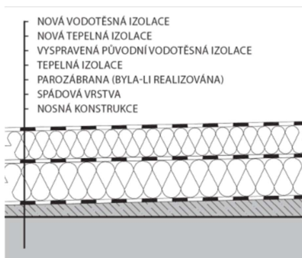
Obr. 6 - PLUS střecha (převzato z [ http://fast10.vsb.cz/studijni-materialy/ps4/5.html ])
