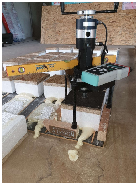
Obr. 29 - Připevnění ocelového plátu (zdroj autor)
