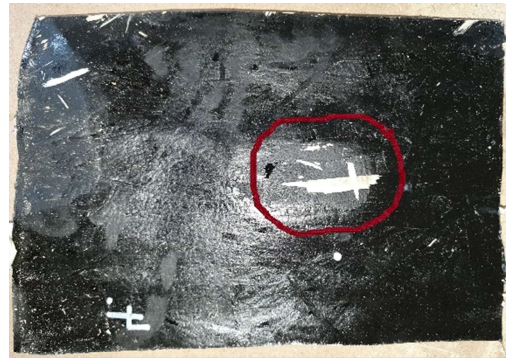
Obr. 35 - Vyříznutý asfaltový pás z oblasti, kde se nacházel vzorek EPS (zdroj autor)
