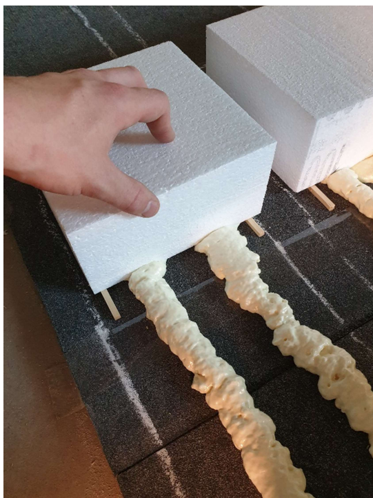
Obr. 25 - Kladení vzorků tepelné izolace (zdroj autor)
