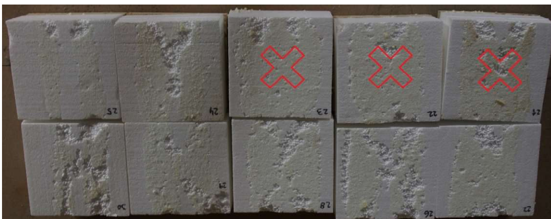
Obr. 45 - Porušení vzorků tepelné izolace s vyznačením neplatných vzorků, uspořádání odpovídá předešlým fotkám (zdroj autor)
