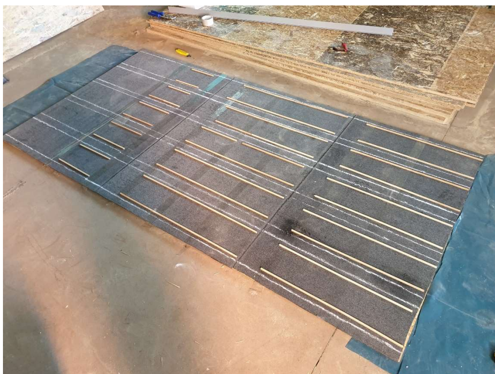
Obr. 17 - Simulace nerovností pomocí distančníků (zdroj autor)
