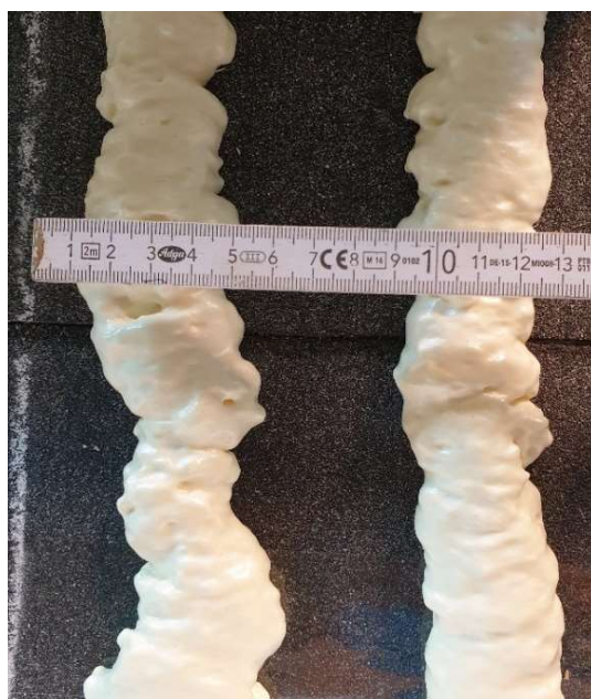
Obr. 21 - Tloušťka nanesených pruhů lepidla (zdroj autor)
