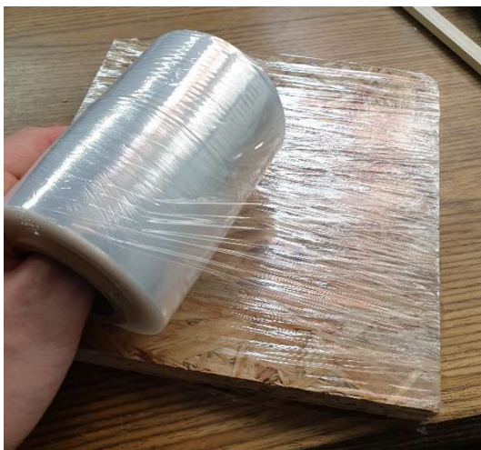
Obr. 46 - Potažení OSB destičky strečovou fólií (zdroj autor)
