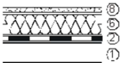
Obr. 4 - Jednoplášťová střecha s opačným pořadím vrstev (převzato z [ http://fast10.vsb.cz/studijni-materialy/ps4/5.html ])
