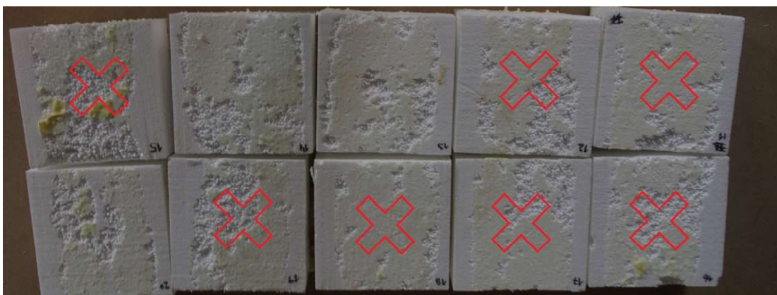
Obr. 42 - Porušení vzorků tepelné izolace s vyznačením neplatných vzorků, uspořádání odpovídá předešlým fotkám (zdroj autor)
