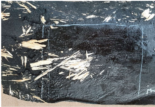
Obr. 36 - Vyříznutý asfaltový pás z oblasti, kde se nacházel vzorek EPS (zdroj autor)
