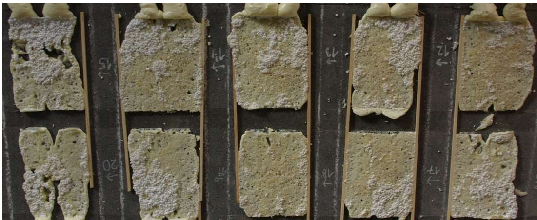
Obr. 40 – Zbylé lepidlo na podkladu po odtrhových zkouškách (zdroj autor)
