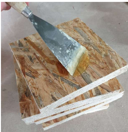
Obr. 27 - Lepení pomocných OSB destiček (zdroj autor)
