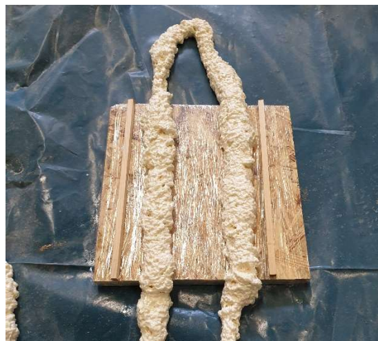
Obr. 47 - nanesené lepidlo před cyklickým zatížením (zdroj autor)
