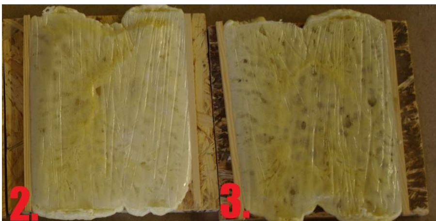
Obr. 54 - Pohled na vytvrzené lepidlo u vzorku č. 2 a č. 3 (zdroj autor)
