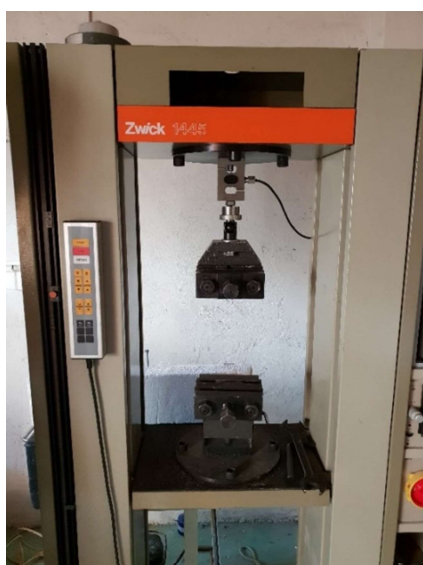
Obr. 48 - Elektromechanické zkušební zařízení (zdroj autor)
