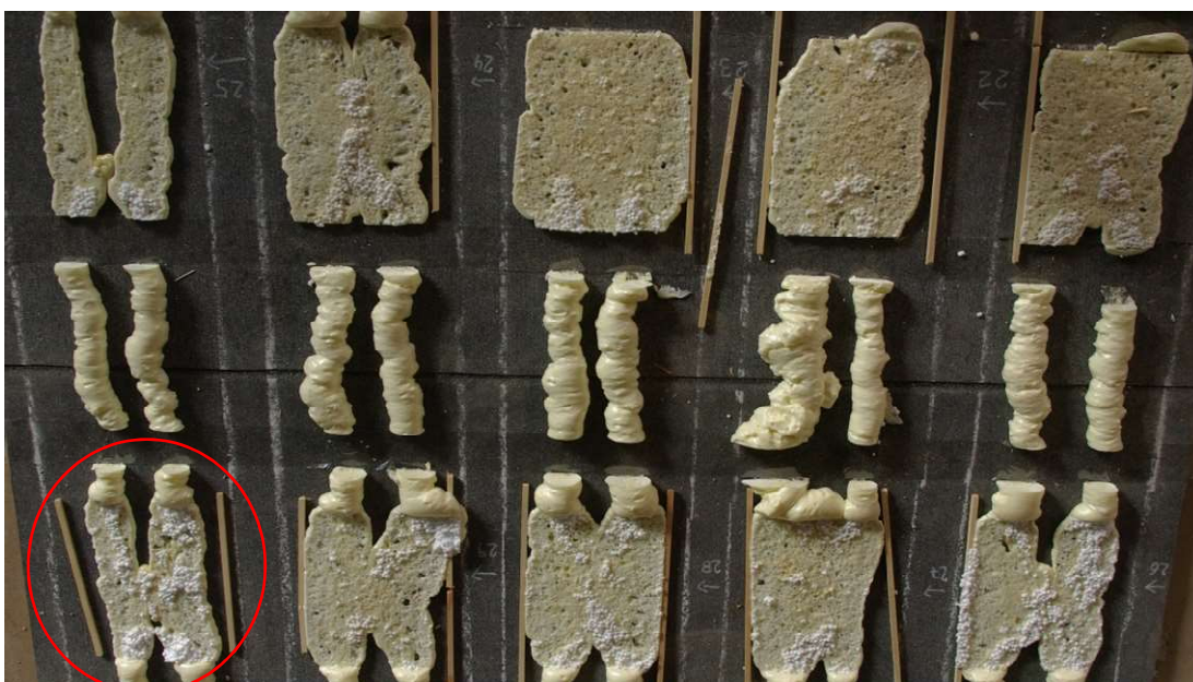
Obr. 43 - Zbýlé lepidlo na podkladu po odtrhových zkouškách (zdroj autor)
