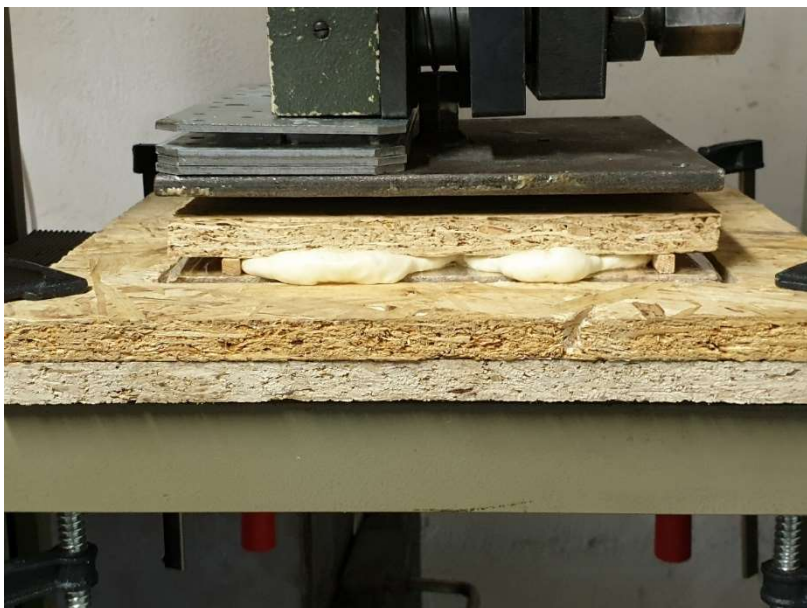
Obr. 49 - Vzorek při cyklickém zatěžování na elektromechanickém zkušebním zařízení (zdroj autor)
