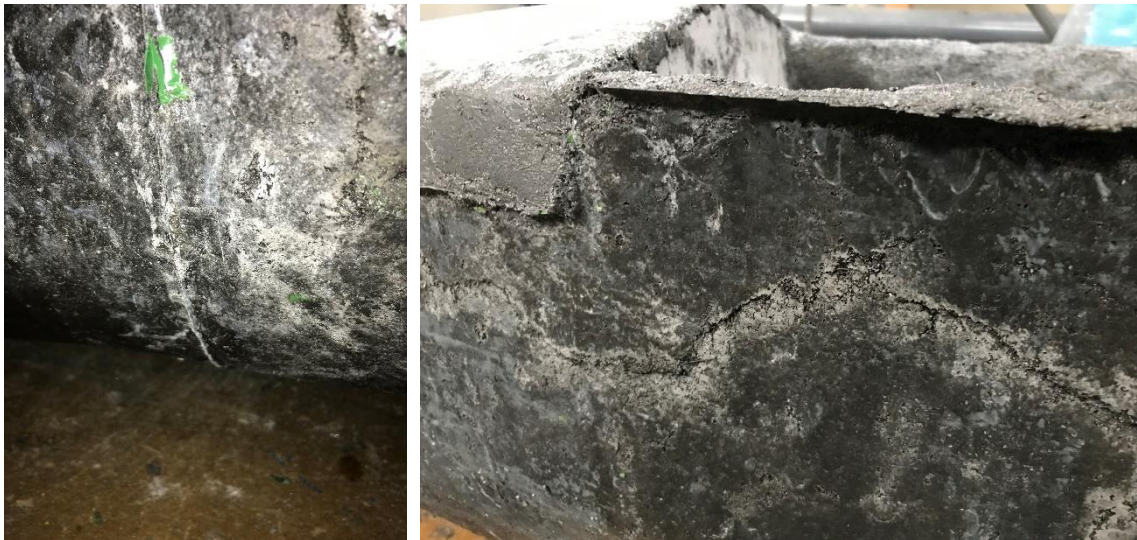
Obr. 7.4 - Detail prstence v montážní spáře formy a odtrženého gelcoatu (vlevo) a detail pracovní spáry na povrchu odbedněné lodi (vpravo)
