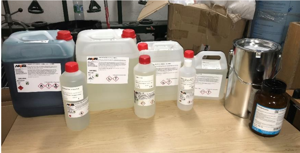
Obr. 4.1 - Veškerá potřebná chemie k výrobě sklolaminátové formy
