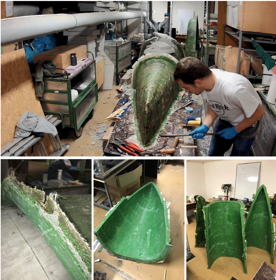
Obr. 4.4 - Oddělování hotové formy od kopyta (nahore), detail čelní desky, přes kterou budou spojeny jednotlivé díly formy (vlevo dole), zadní díl formy (uprostřed dole ) a všechny tři díly formy (vpravo dole)
