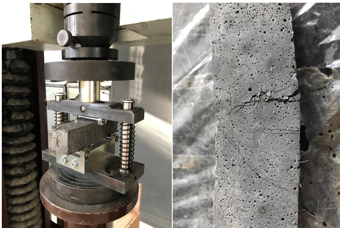
Obr. 6.4 – Testování trámečků (vlevo) a zlomený trámeček (vpravo)
