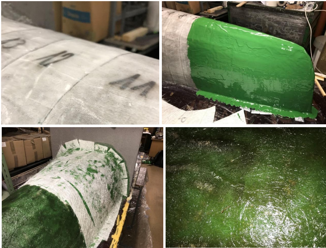
Obr. 4.3 - Matný povrch po několikanásobné aplikaci separačního vosku (vlevo nahoře), aplikace gelcoatu (vpravo nahoře), ukládání výztužné skelné rohože do živého gelcoatu (vpravo dole) a detail zatvrdlé struktury výsledného sklolaminátu
