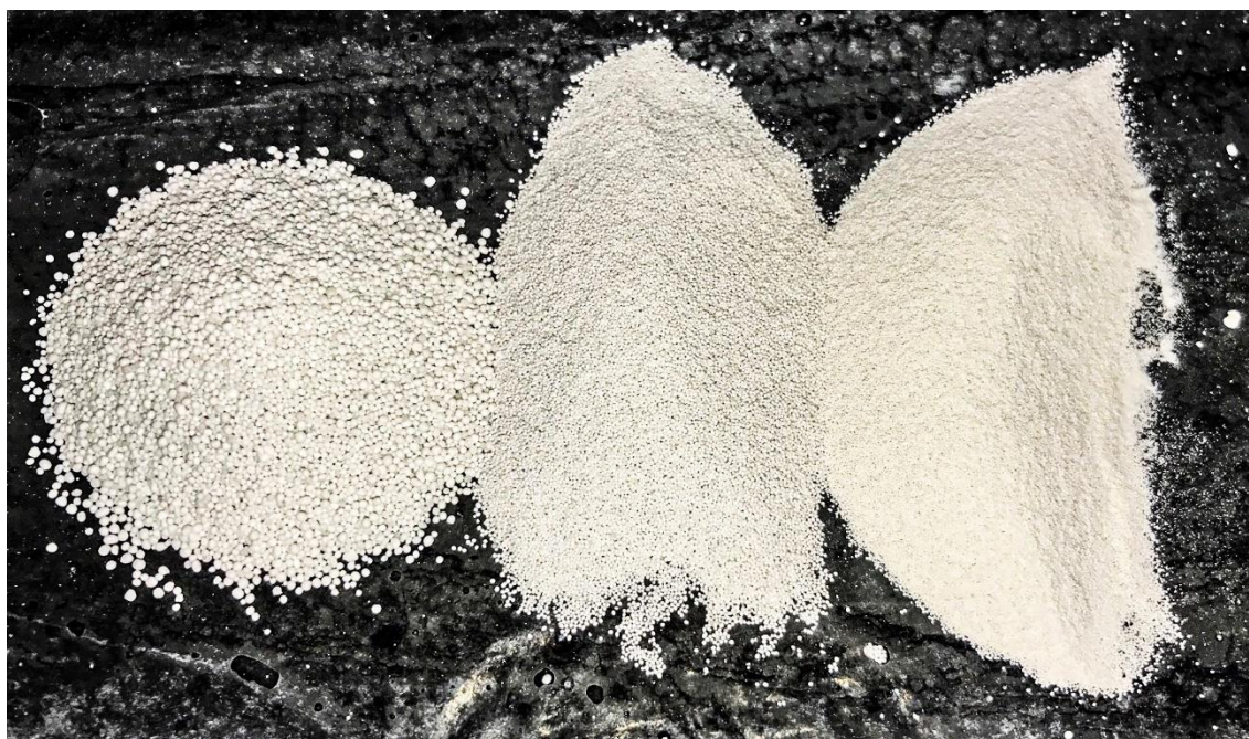
Obr. 6.1 – Použité frakce lehčeného kameniva Poraver, zleva frakce 0,5-1 mm, 0,25-0,5 mm a 0,1-0,3 mm
