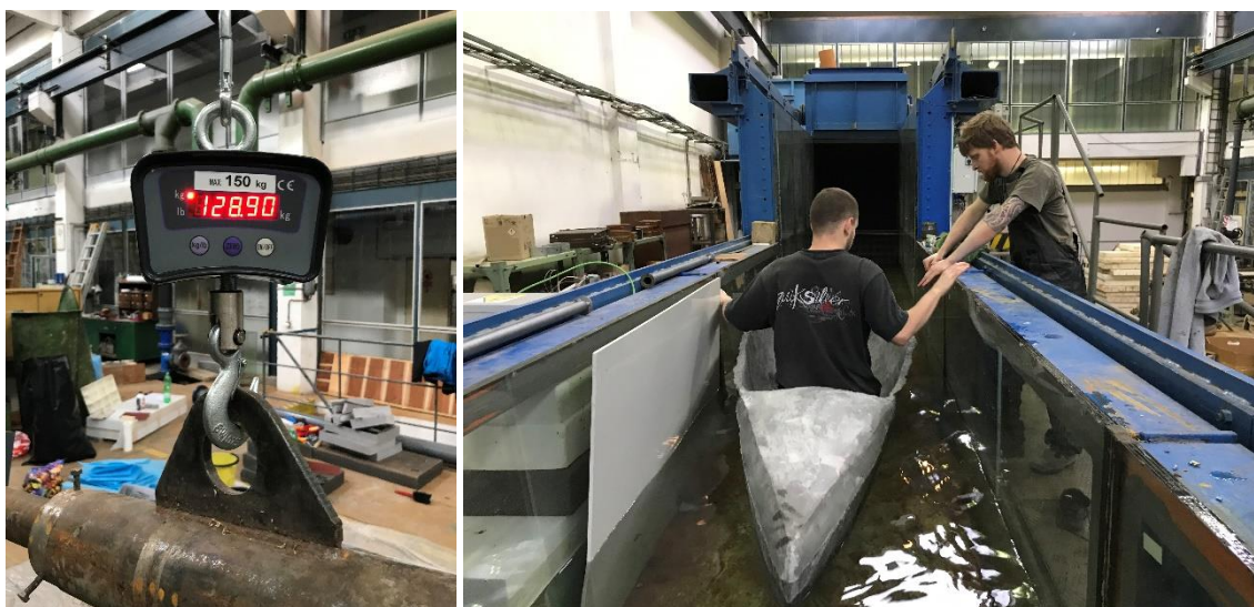
Obr. 7.6 - Vážení kánoe pomocí jeřábové váhy a vahadla (vlevo), testování první kánoe ve vodním kanále ve školní laboratoři (vpravo)
