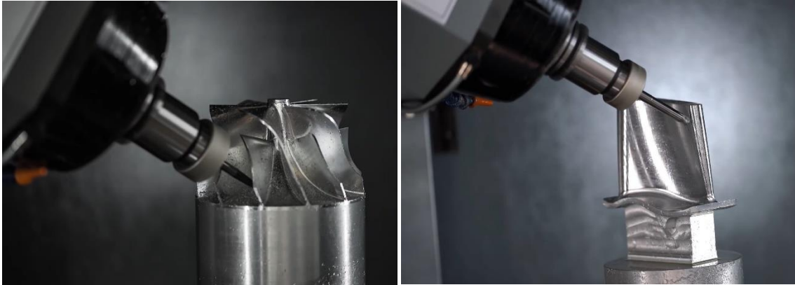
Obr. 3.1 - Ukázka, jak moc komplexních tvarů se dá při použití pětiosé frézy docílit [7]
