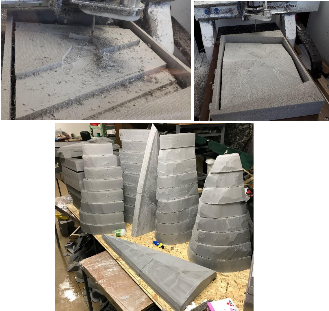
Obr. 4.6 - fréza obrábějící část jedné z kapotek (vlevo nahoře), výsledná dokončená část kapotky (vpravo nahoře), složená kapotka a připravené vycpávky pod kapotky
