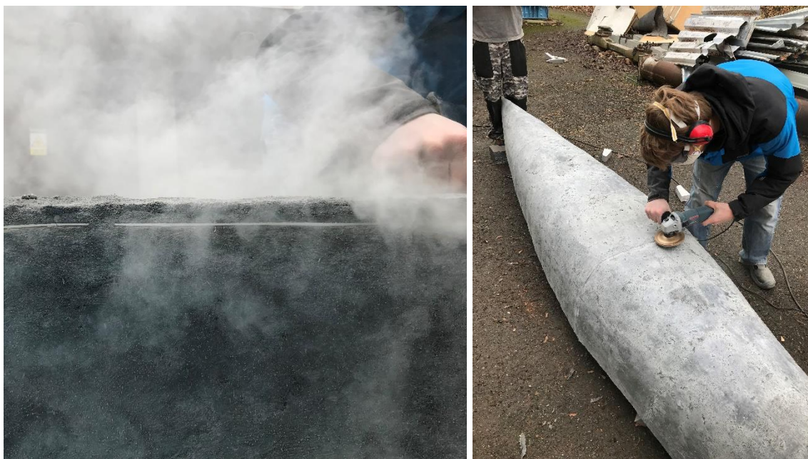
Obr. 7.7 - Venkovní zarovnávání bordu pomocí úhlové brusky a ukázka vysoké prašnosti při řezání (vlevo), broušení prstence v místě spáry bednění (vpravo)
