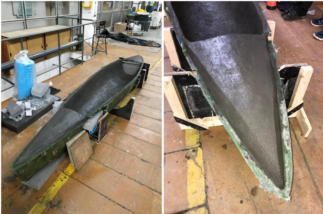
Obr. 7.3 - Hotová kánoe před obalením folií proti odpařování vody (vlevo), detail čerstvě vybetonované přední kapotky (vpravo)
