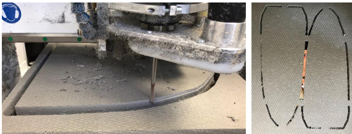
Obr. 3.4 - CNC fréza při obřezávání profilu z XPS (vlevo) a výsledné vyřezané profily dosud spojené s deskou (vpravo)
