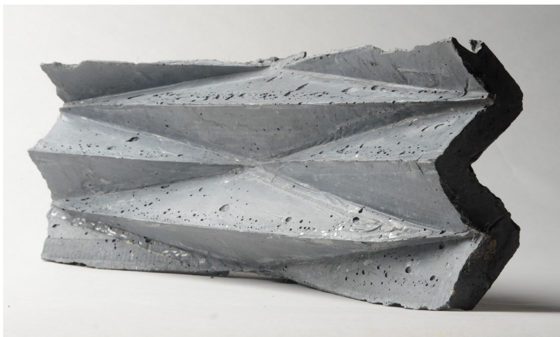
Obrázek 30: Betonový vzorek z papírového bednění
