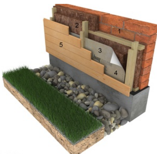
Obrázek 4 - Popis skladby s provětrávanou mezerou [15]
