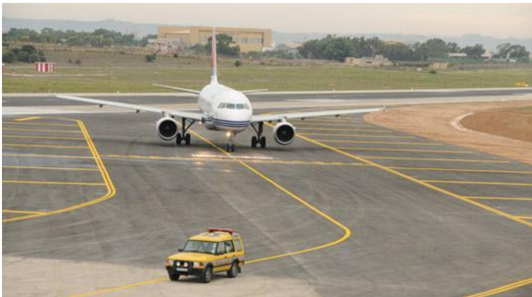
Obr. 5.7.1 Pojezdová dráha - TWY [22]
