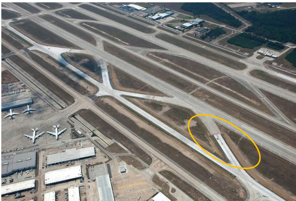
Obr. 5.7.9.3 Pojezdová dráha pro rychlé odbočení – Letiště Houston [23]
