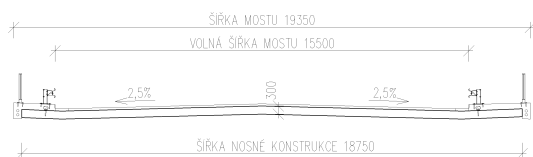
Obr. 2.2: Příčný řez mostním objektem 1
