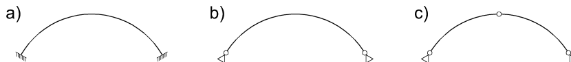
Obr. 3.1: Příklady statického působení oblouků: a) vetknutý oblouk, b) dvoukloubový oblouk, c) trojkloubový oblouk
