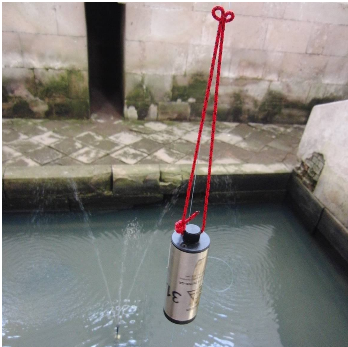
Obr. 29: Severní bazén - pohled na zavěšené čidlo Mimikin TH s označením 31 (Foto: J. Řehák)
