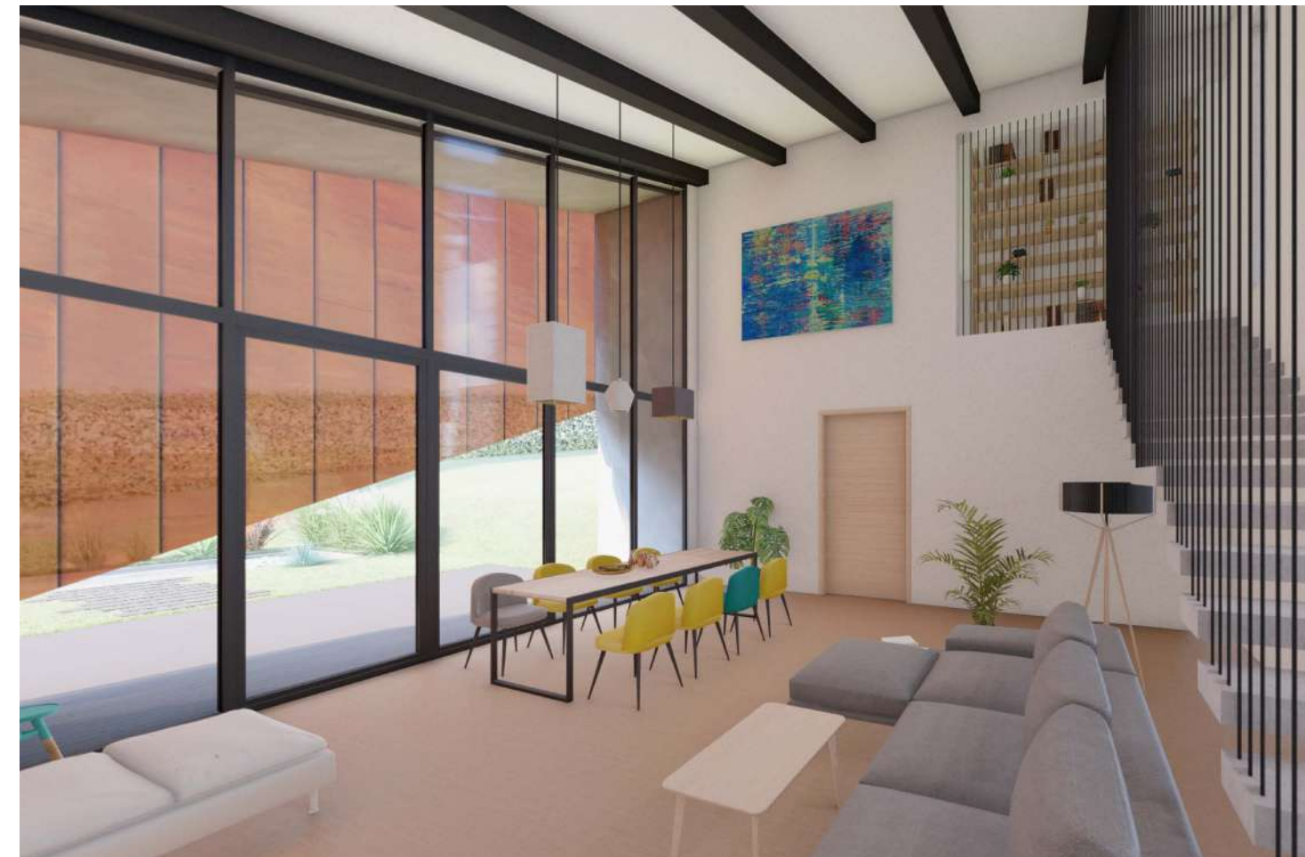
INTERIÉR: Pohled do interiéru obývacího pokoje poukazuje na vzdušnost prostoru a industriální pojetí interiéru. Přiznané šikmé nosníky tvoří zajímavý prvek spolu s ocelovými lankami schodiště. Mezi nosníky probíhá i vedení VZT, které je řešeno jako přiznané přírodní a odvodní potrubí ve falešném trámu. Šikmina z cortenu je perforována, nejvyšší bod průchodu je v 2650mm, poskytuje tedy kvalitní vstup na zahradu, i když se to zprvu nezdá.
