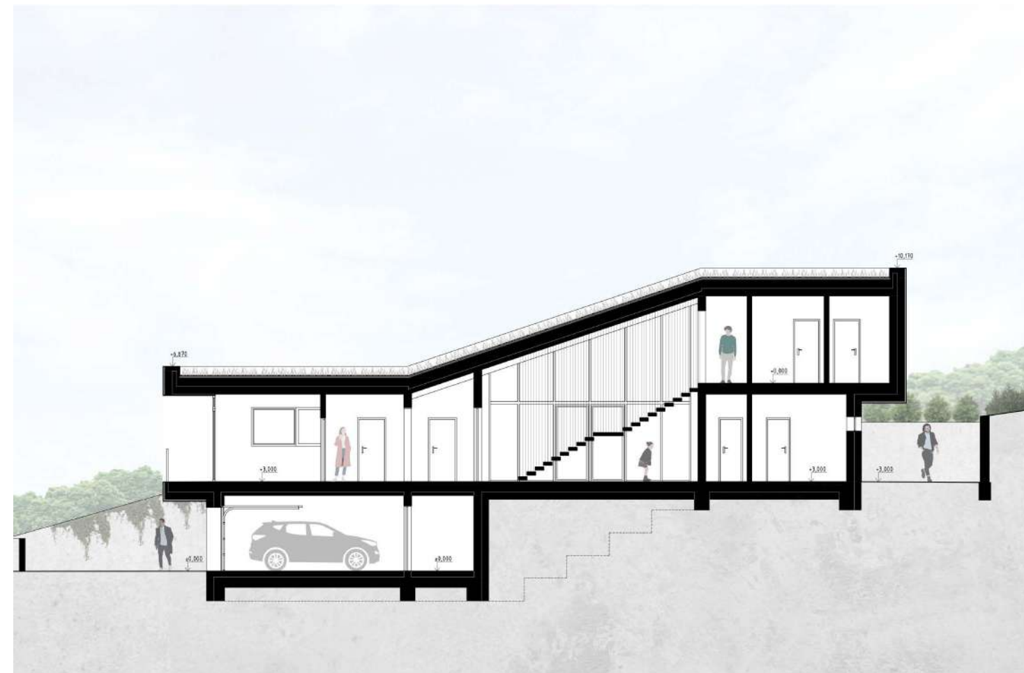
ŘEZ: Členění hmoty ve vertikálním směru začíná hned od vstupního podlaží, kde dochází k oddělení rodiny a nájemníku. Za garáží se nachází technické zázemí. Ve 2.NP je umístěn obývací pokoj, který se otevírá přes dvě patra a vytváří velký osvětlený prostor, který je stíněn díky perforovanému cortenovému plechu. Zapuštěná terasa na konci hmoty vytváří sekundární posezení, které bude díky orientaci a zastínění ideálním prostorem během letních dnů. Konzola vytváří i kryté sezení.
