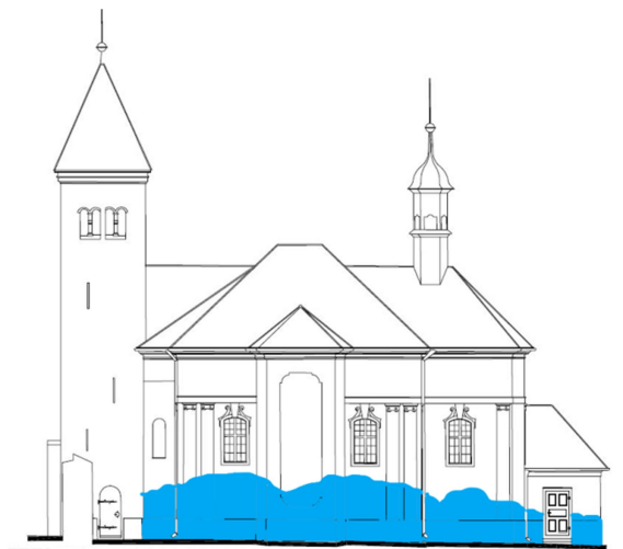
obr. 44 Schéma pohledu na jižní fasádu s vyznačenou vlhkostí
