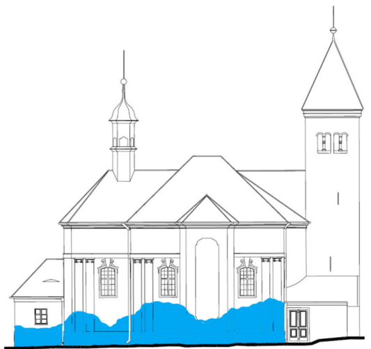
obr. 43 Schéma pohledu na severní fasádu s vyznačenou vlhkostí
