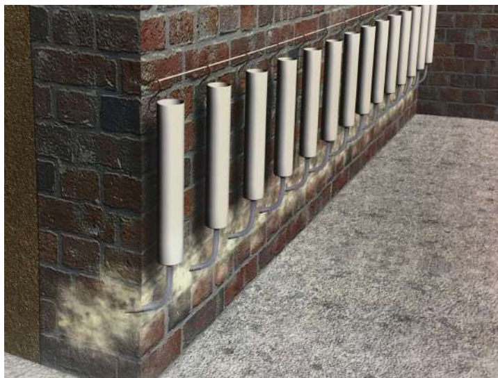
Obr. 3.9: beztlaková injektáž (infuze), převzato z [19]
