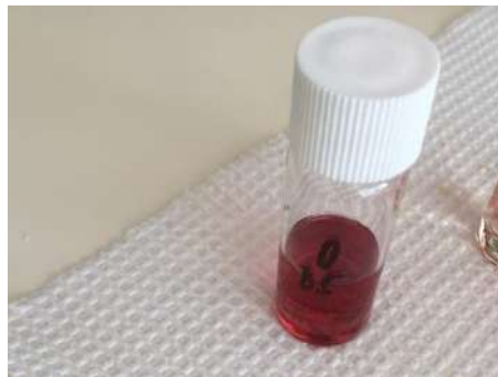
Obr. 6.2: vzorek odebraný ze zdiva kláštera připravený pro stanovení síranů
