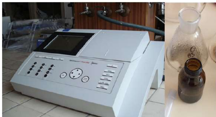
Obr. 6.1: stanovení obsahu solí, přístroj UV–VIS fotometru Spectroquant Pharo 300, vodný roztok
