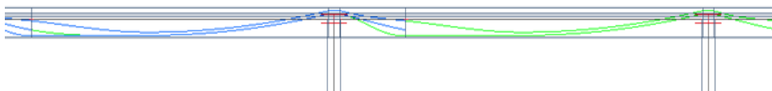
Obrázek 84 Předpínání hlavní nosné konstrukce - 4. fáze
