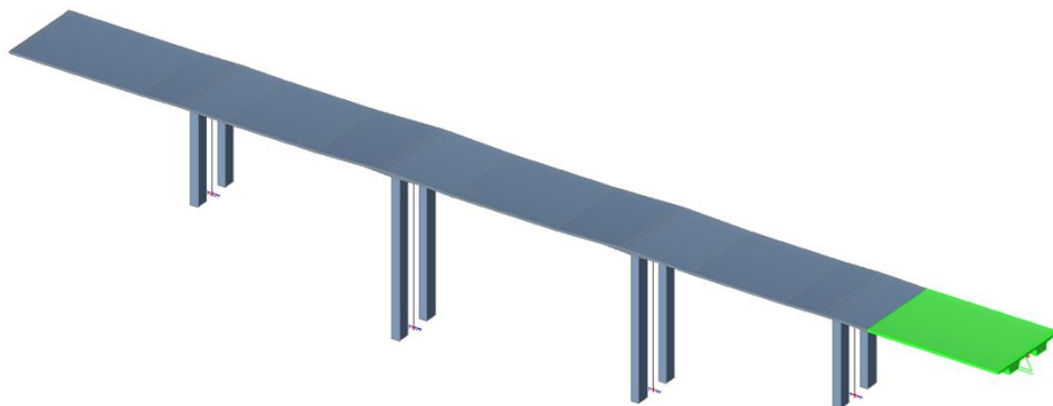
Obrázek 137 Betonování páté fáze
