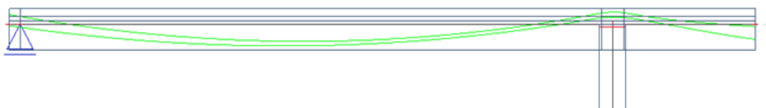
Obrázek 78 Předpínání hlavní nosné konstrukce - 1. fáze
