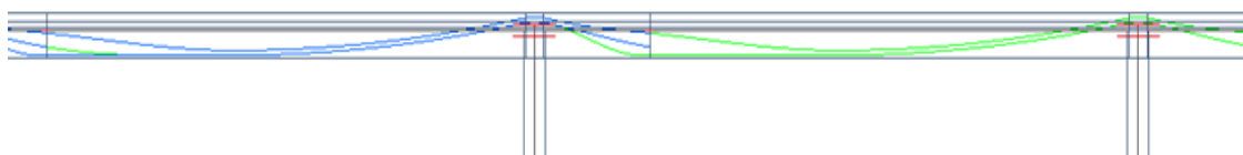
Obrázek 82 Předpínání hlavní nosné konstrukce - 3. fáze
