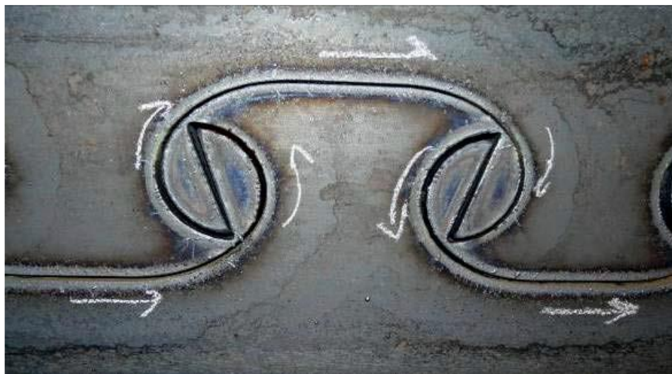
Obr. 18 Způsob řezání spřahujícího prvku MCL [15]
