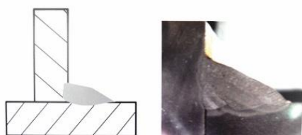
Obr. 14: Nadměrná asymetrie koutového svaru; životnost svařované konstrukce snížena o 75 %
