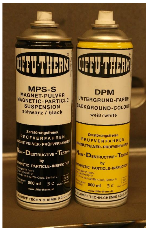
Obr. 41: Zkušební prostředek pro barevnou metodu (bílá kontrastní barva – vpravo, černý indikační prášek – vlevo)
