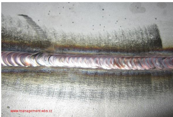
Obr. 32: Příliš uspěchaný svar. Housenka je roztáhlá [17]
