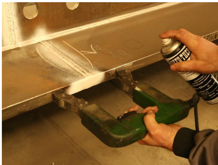
Obr. 42: Provádění magnetické zkoušky pomocí jha
