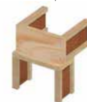
Detail uložení stropních/střešních nosníků s vykonzolováním na stěnové nosníky
