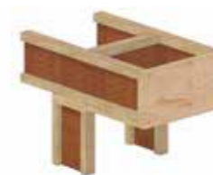
Detail uložení stropních/střešních nosníků s vykonzolováním na stěnové nosníky
