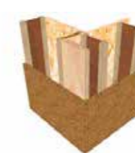
Detail uložení stropních/střešních nosníků s vykonzolováním na stěnové nosníky
