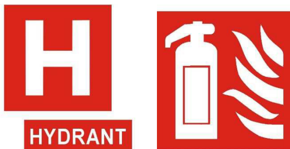
Obrázek 1 Požární značka hydrant a PNP
