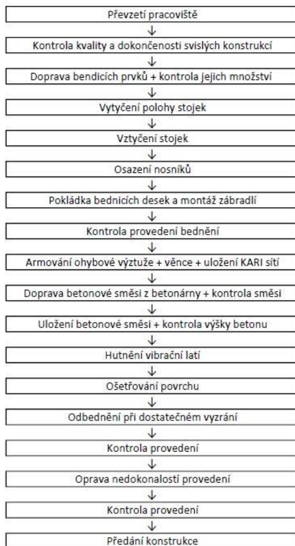
Postupový diagram 1 – realizace monolitického železobetonového stropu deskového Zdroj: vlastní zpracování na základě Monolitických ŽB stropů – PERSTAV s.r.o.
