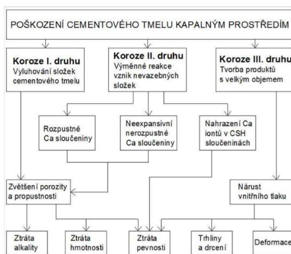
Obrázek 6 Schéma poškození betonu kapalným agresivním prostředím [26]
