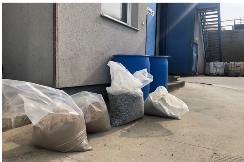
Obr. 1 – Materiál připravený na betonárně na převoz do laboratoře K-133
