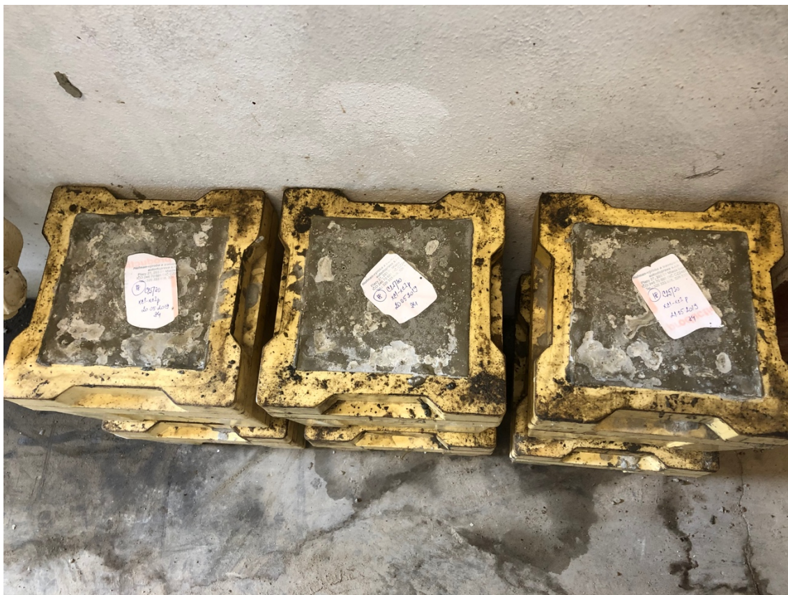
Obr. 10 – Výroba zkušebních těles v podmínkách betonárny
