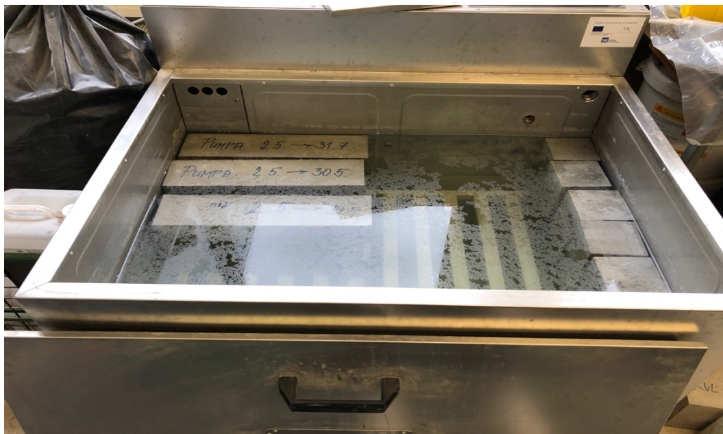
Obr. 6 – Vodní lázeň s kontrolou teploty sloužící k ošetřování zkušebních těles
