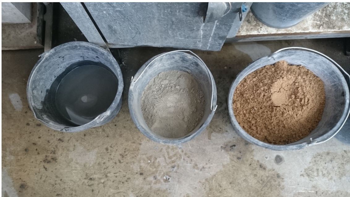
Obr. 3 – Navážené jednotlivé složky betonové směsi připravené pro betonáž
