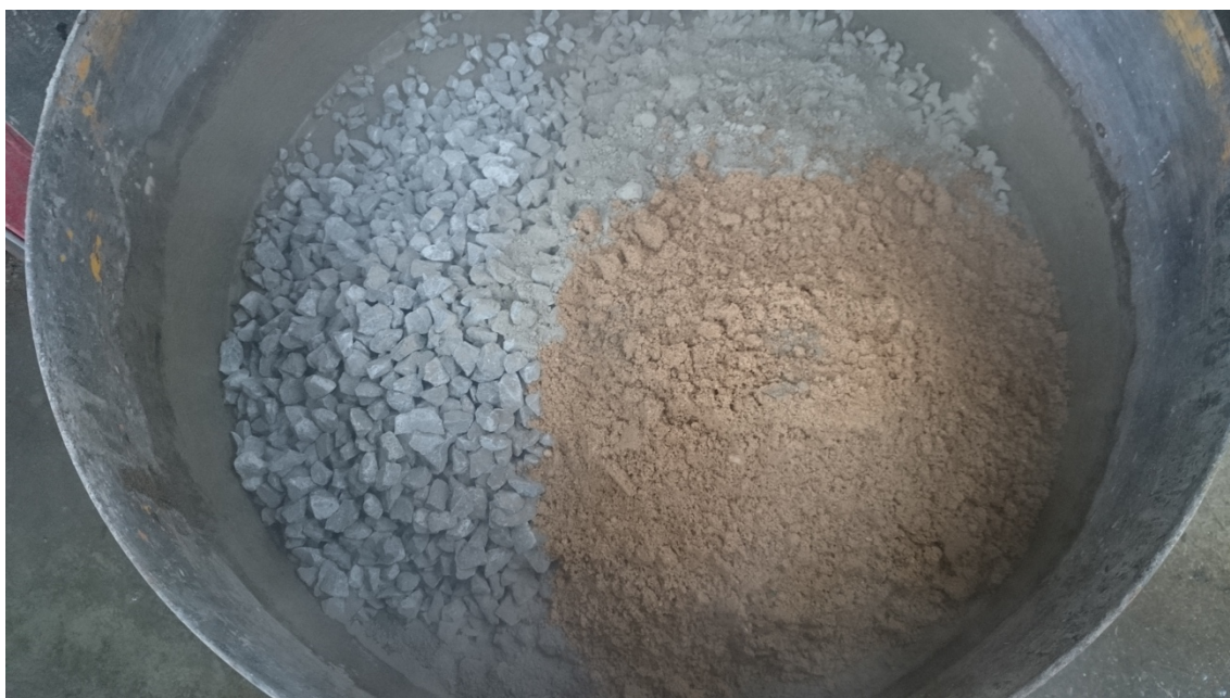
Obr. 4 – Přidávání složek betonu do míchačky
