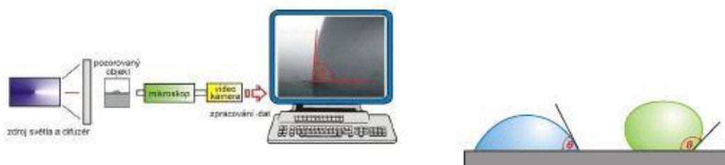
Obr. 2.14: Schéma aparatury (vlevo) a detail na měřený vzorek (vpravo). Převzato z [30].
