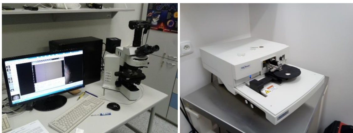
Obr. 3.2.1: Vlevo: Zobrazovací technika: optický mikroskop s digitálním fotoaparátem., získáno v laboratořích KPO na FBMI při ČVUT. Vpravo: Profilometr Alphastep IQ, získáno v laboratořích FZÚ Albertov.
