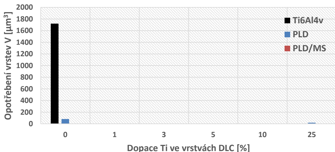
Obr. 4.3.1: Opotřebení vzorků DLC +Ti a substrátu Ti6Al4V při zátěži 1 N spočítaná pouze z dat z profilometru (první metodou).
