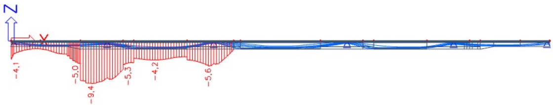
Obrázek 195 - M4, red. průřez, napětí horní vlákna po odbednění II. části
