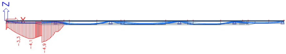
Obrázek 193 - M4, red. průřez, napětí horní vlákna po odbednění I. části
