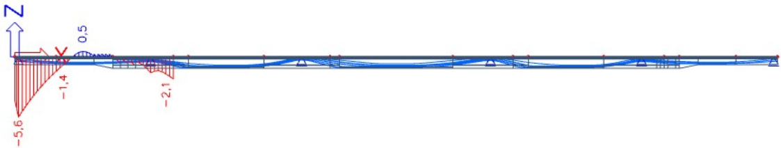
Obrázek 204 - M4, plný průřez, napětí dolní vlákna po odbednění I. části
