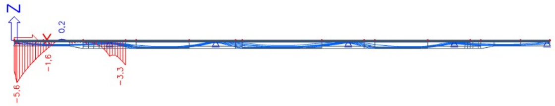
Obrázek 194 - M4, red. průřez, napětí dolní vlákna po odbednění I. části
