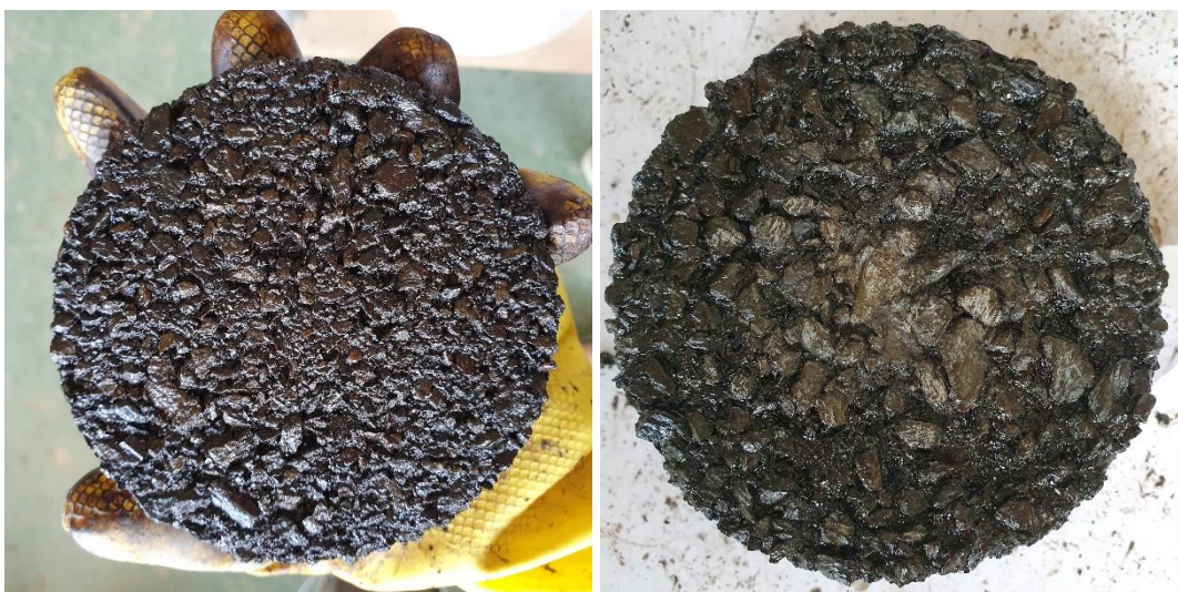
Obrázek 35 – Zkušební těleso namáhané 24 h v separátoru č.4 (vlevo po vyjmutí z kádinky, vpravo po třech sériích kartáčování) [20]
