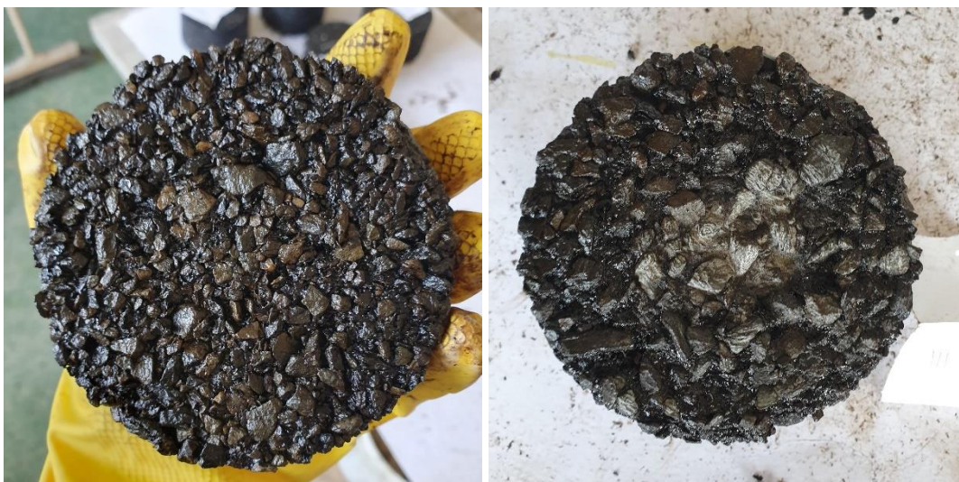
Obrázek 34 – Zkušební těleso namáhané 24 h v separátoru č.3 (vlevo po vyjmutí z kádinky, vpravo po třech sériích kartáčování) [20]
