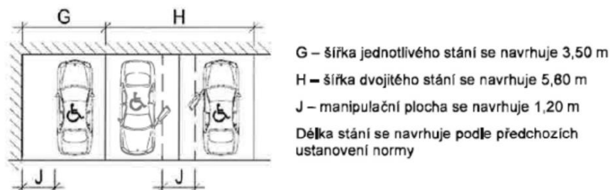
Obr. 4 Uspořádání stání pro vozidla přepravující osoby s omezenými pohybovými schopnostmi (Zdroj: SN 73 6056)
