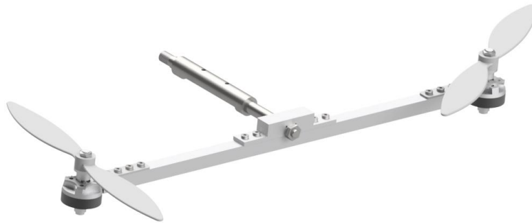
Obr. 8: Horní hřídel s ramenem a servomotory.
