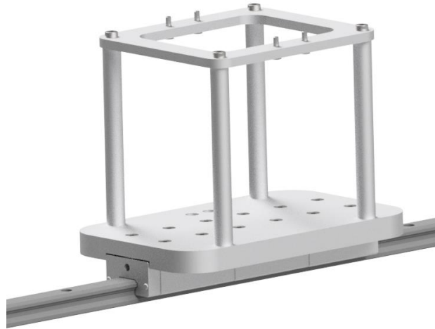
Obr. 6: Základní nosná kostra modelu kvadrokoptéry.
