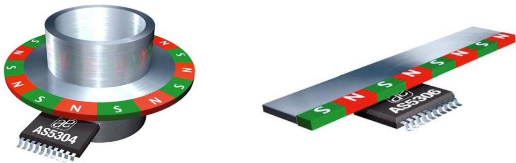
Obr. 16: Senzor AS5304 s magnetickým kruhem (vlevo) a senzor AS5306 s magnetickou páskou (vpravo). [4]
