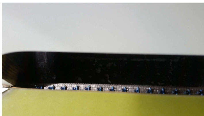
Obrázek 6.4: Pás fototranzistorů na brankové čáře
