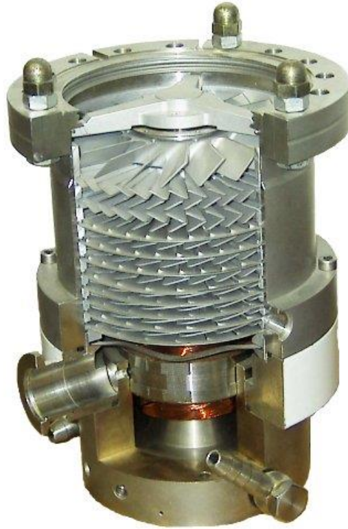
Obr. 13: Turbomolekulární vývěva v řezu (převzato z [26])
