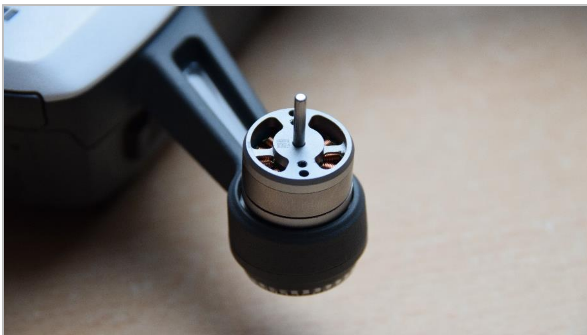
Obrázek 15 – usazení elektromotoru 1504S (zdroj: autor)
