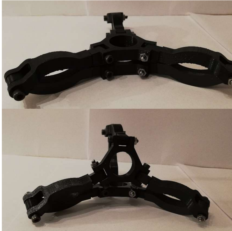
Obrázek 41: Model vytisknutého manipulátoru Canfield joint
