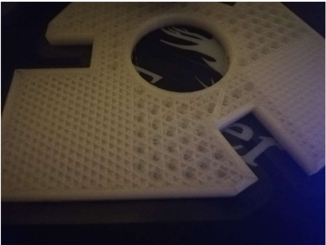
Obrázek 42: Průběh tisknutí Základní plošiny J1
