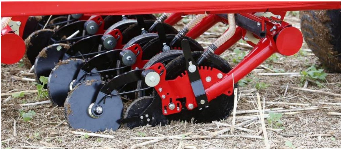
Obrázek 32 – uložení secích botek na rám stroje [27]
