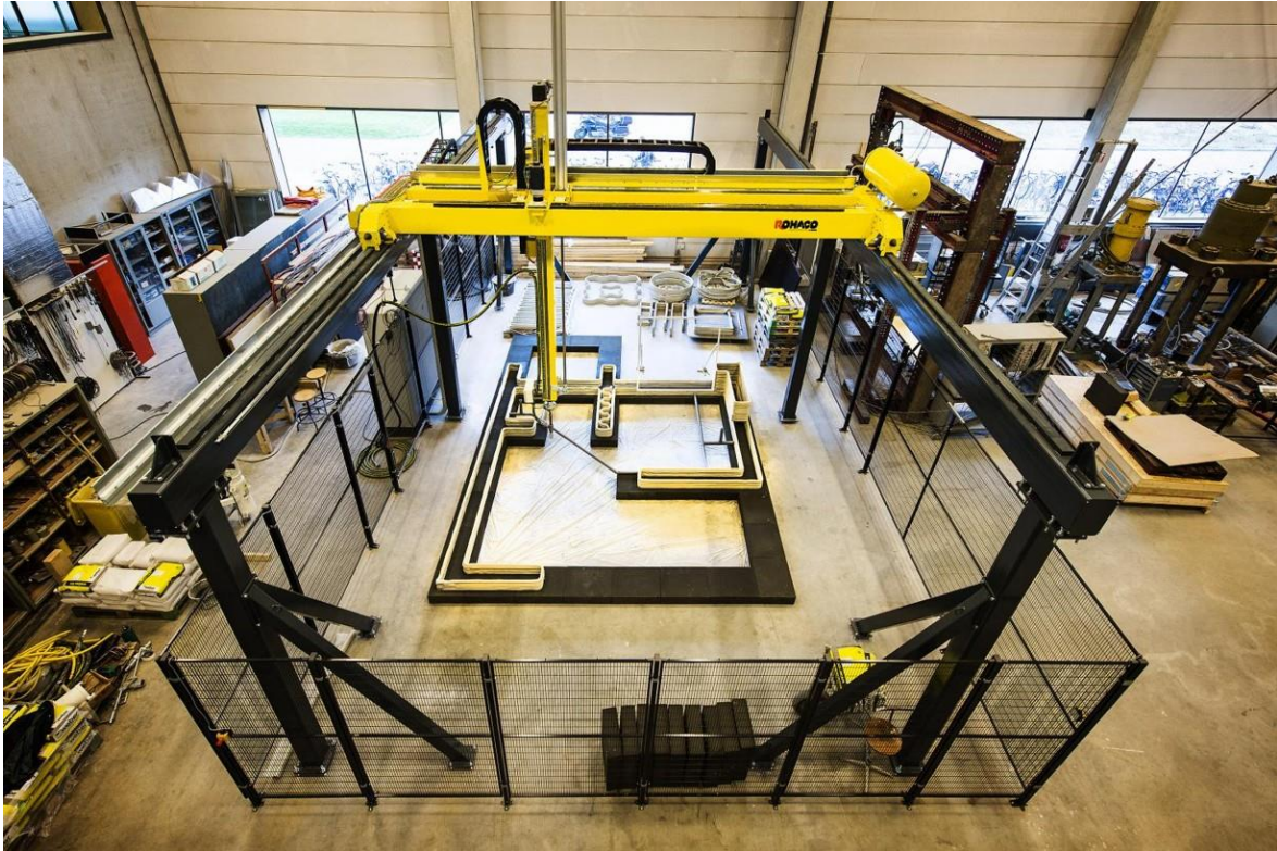
obr. 5.: 3D tiskárna s rámovou konstrukcí [1]
