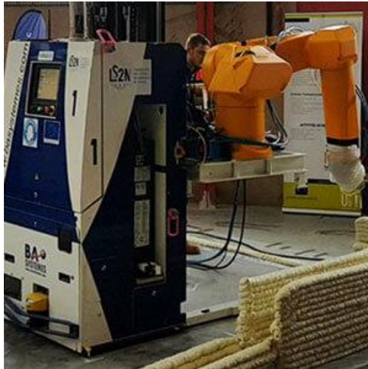
obr. 6.: 3D tiskárna s robotickým ramenem [4]
