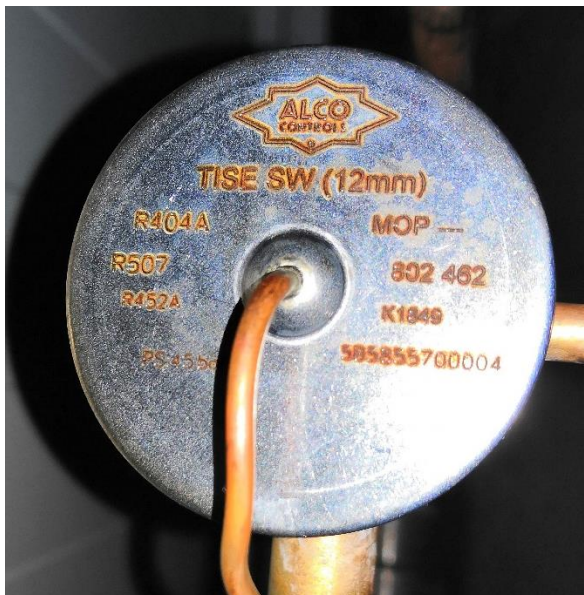
Obr. 33: Termostatický expanzní ventil TISE SW (12 mm) ve zkušebním okruhu CL20 [20]
