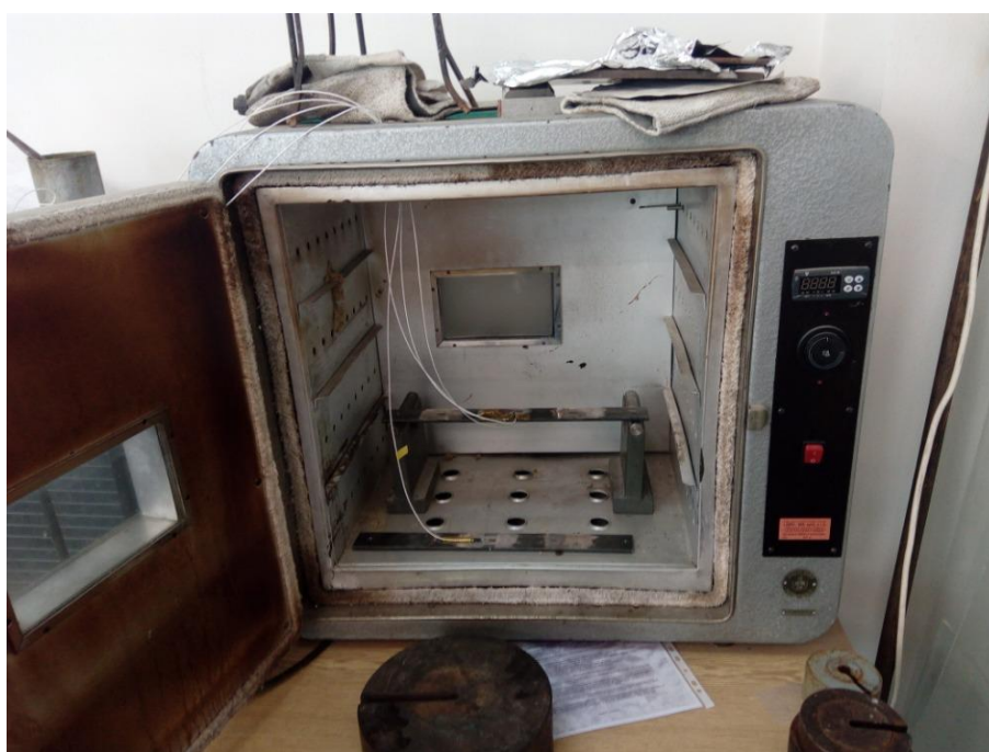
Obr. 27 Nosníky připravené k měření umístěné v laboratorní peci
