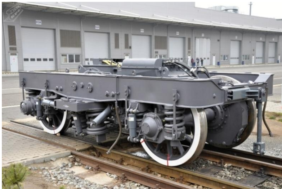
Obr. 6: Podvozek lokomotivy řady 363.5 s hvězdicovými obručovými koly [12]
