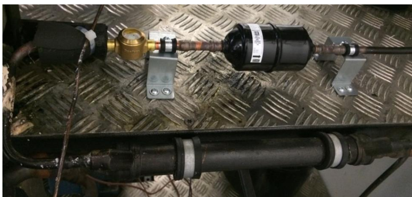
Obrázek 3-6 Výměník trubka v trubce Danfoss v dolní části, průhledítko a filtrdehydrátor Danfoss v horní části
