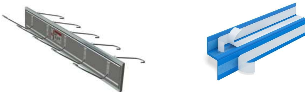
Obrázek 3 Typický prvek vkládaný mezi podestu a rameno schodiště monolitického (vlevo) a prefabrikovaného (vpravo) [5]
