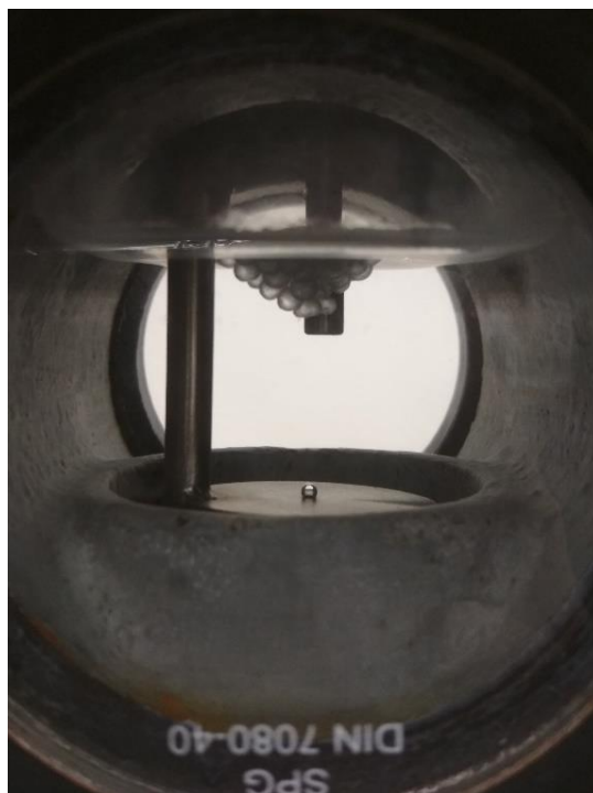
Obrázek 16: Malým otvorem jsou puštěny bublinky plynu, ze kterých se následně tvoří hydráty, které jsou vidět u hladiny.
