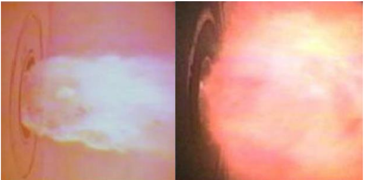
Obr.6. Plamen při použití konvenčního hořáku (vlevo) a Low- \text{NO}_x hořáku (vpravo).
