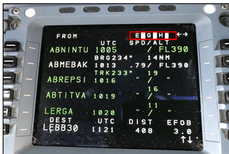
Obrázok 11: Volací znak v systéme FMS. Foto: autor
