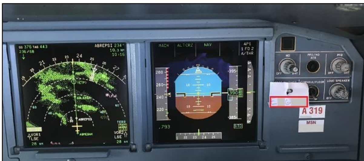
Obrázok 10: Umiestnenie poznámky volacieho znaku v kokpite. Foto: autor
