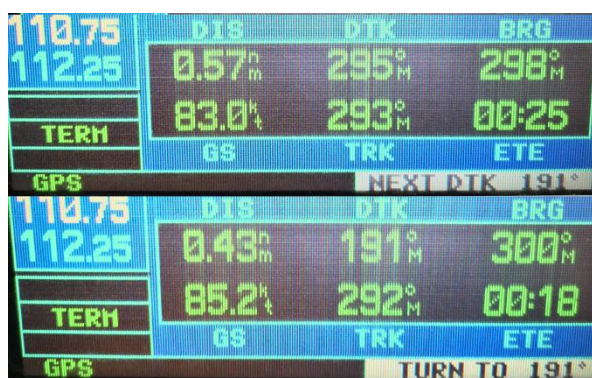
Obrázek 75 Waypoint alert (nahore) a trun advisory (dole). Všimněte si navigačních parametrů na horním a dolním obrázku - DIS, GS a změnu DTK.
