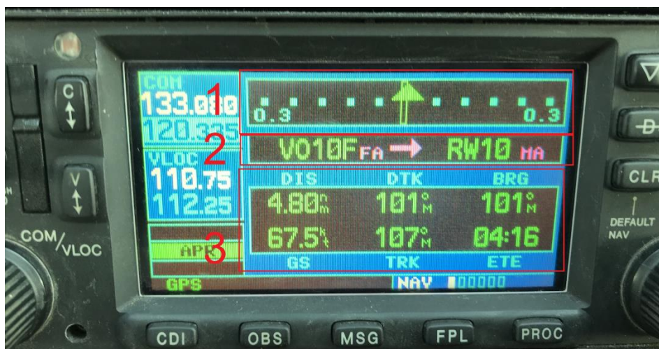
Obrázek 57 První strana módu NAV - "default NAV" . 1 - zobrazení CDI. Stejný výnos je přenášen na mechanický přístroj - číselná hodnota odpovídá maximální výchylce a zelený obdélník aktuální odchylce 2 - aktivní segment trati 3 - navigační datová pole.
