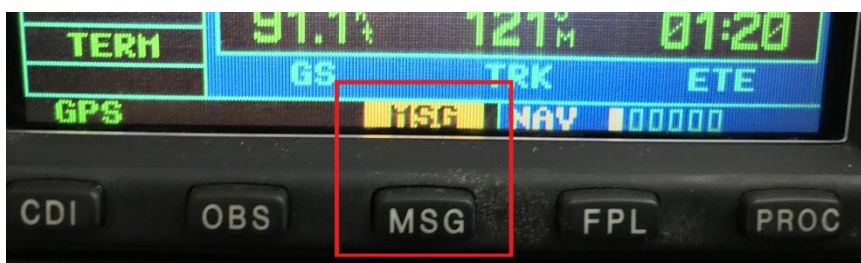
Obrázek 64 Indikace nové zprávy - pole MSG bliká žlutým podbarvením. Pro zobrazení je nutné stisknout tlačítko MSG.
