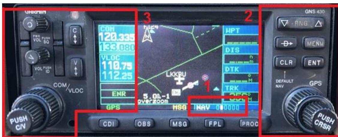
Obrázek 56 Rozdělení ovladačů GNS430. 1 - indikace módu a strany, 2 - ovládání NAV 3 - ovládání radiostanic (včetně VOR/ILS).
