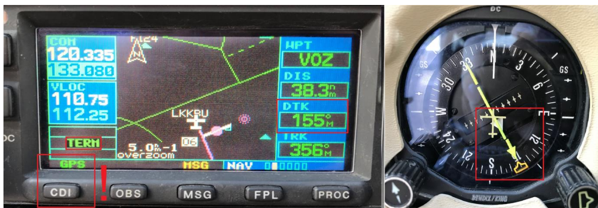
Obrázek 73 Správné nastavení před odletem. Zvláštní pozornost je nutné věnovat přepnutí navigačního výnosu do módu GPS.
