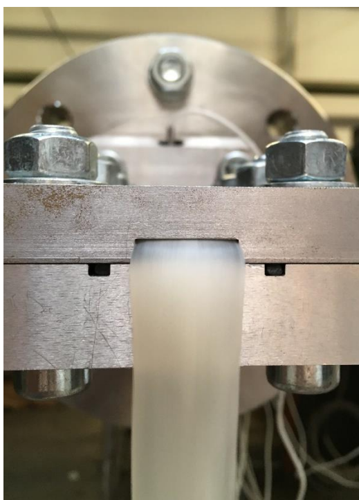
Obrázek 44: Fotografie kolagenní hmoty na výstupu z kapiláry č.6
