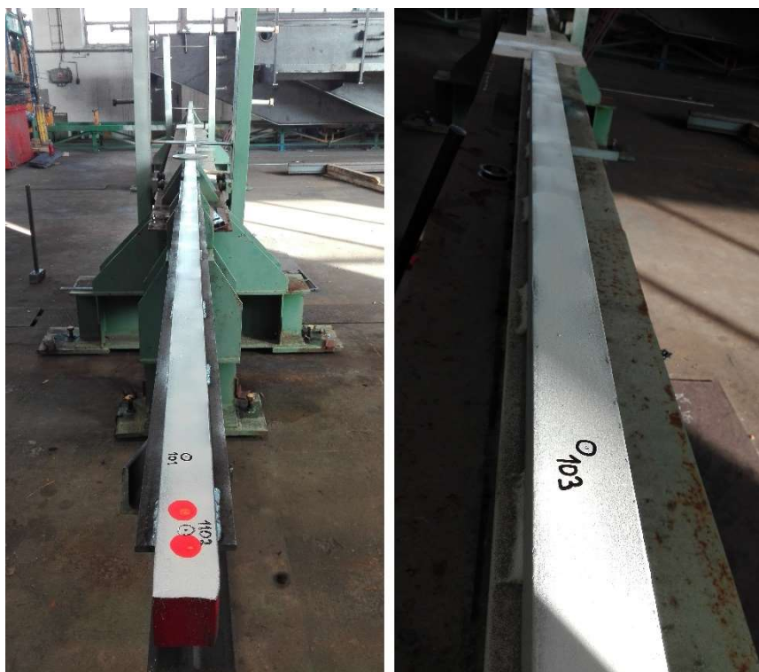
Obr. 14- Síť bodů na kolejnicích stolic
