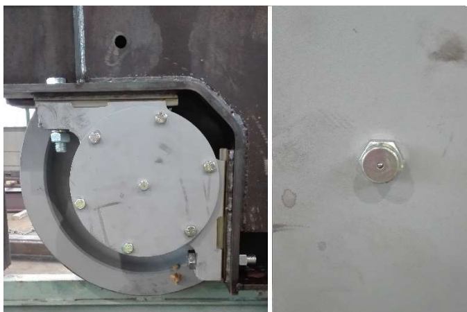
Obr. 24- Střed vnitřního kola příčnicku
