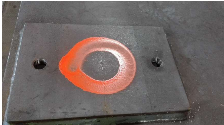
Obr. 25- Vytyčený bod na podkladnici
