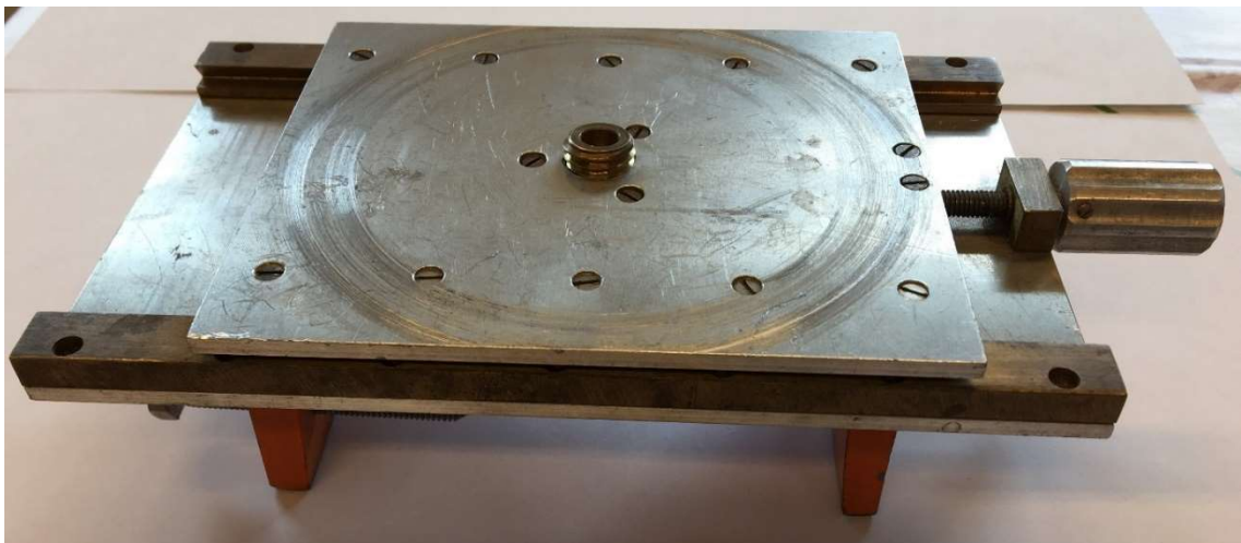
Obr. 54- Univerzální držák totální stanice na kolejnici
