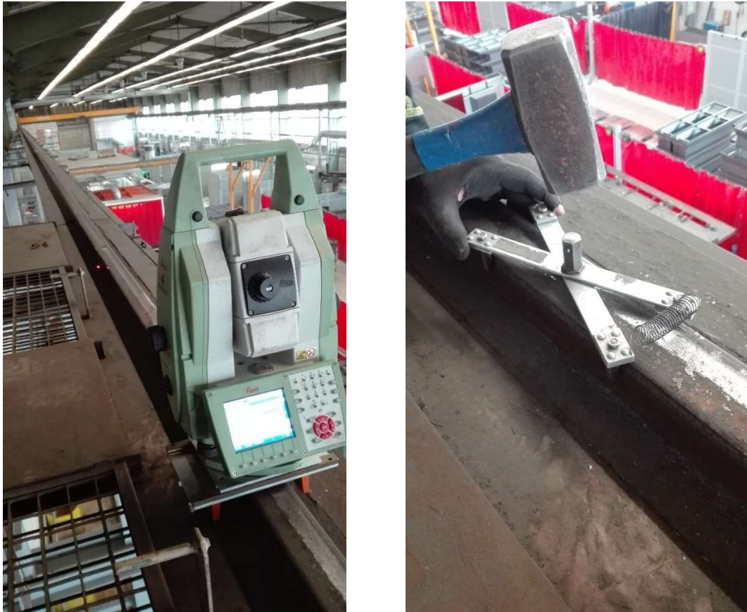
Obr. 55- Umístění totální stanice na kolejnici a použití středících nůžek
