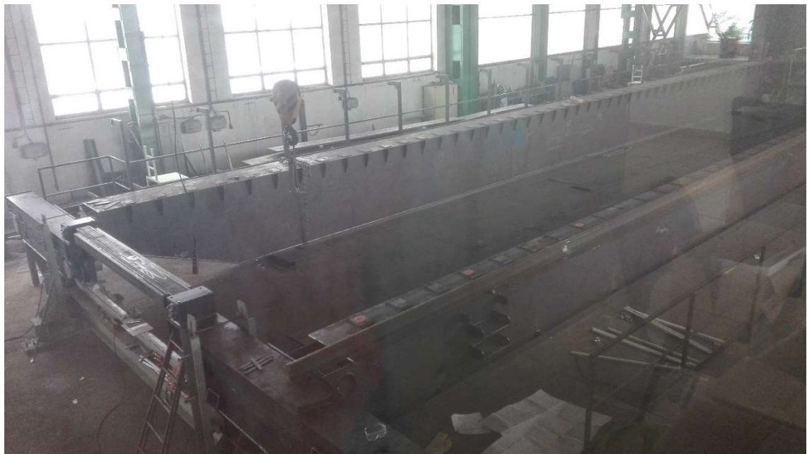
Obr. 28- Sestavený mostový jeřáb
